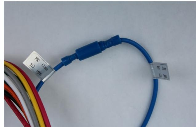
**3A. Inserte el tablero de circuitos impresos X-13 en el arnés de cables (para aplicaciones X-13, únicamente)**
